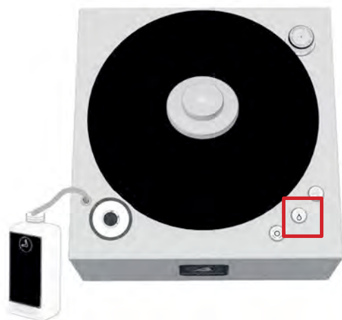
Image 11 : Vidage du réservoir de liquide
