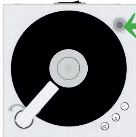
Image 2 : Remplissage du réservoir de fluide
