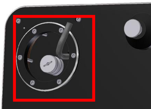
Abb. 13: Einstellung des Antiskating
