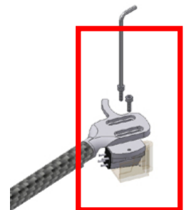
Abb. 5: Montage des Tonabnehmers
