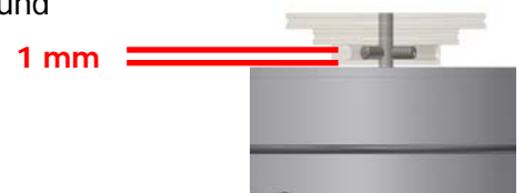
Abb. 13: Befestigen des Antriebsrads
