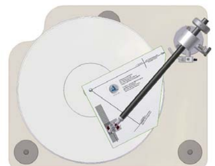
Abb.9: Absenken des Tonabnehmers auf der Schablone
