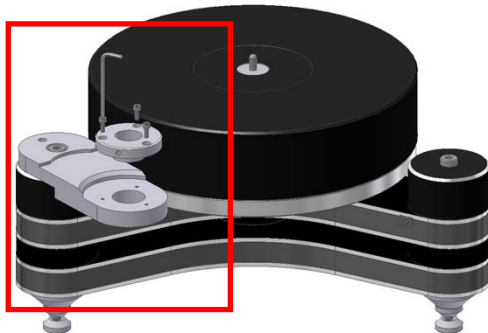
Abb. 7: Montage der Tonarmbasis ohne VTA-Lifter
