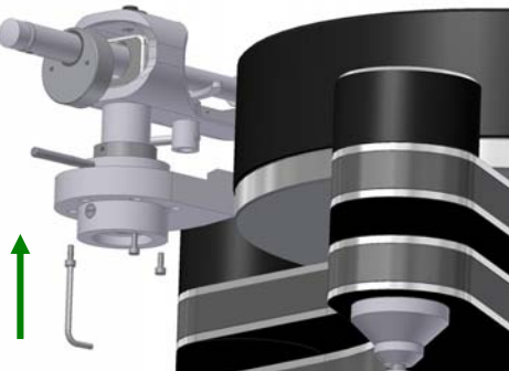
Abb. 3: Montage des VTA-Lifter
